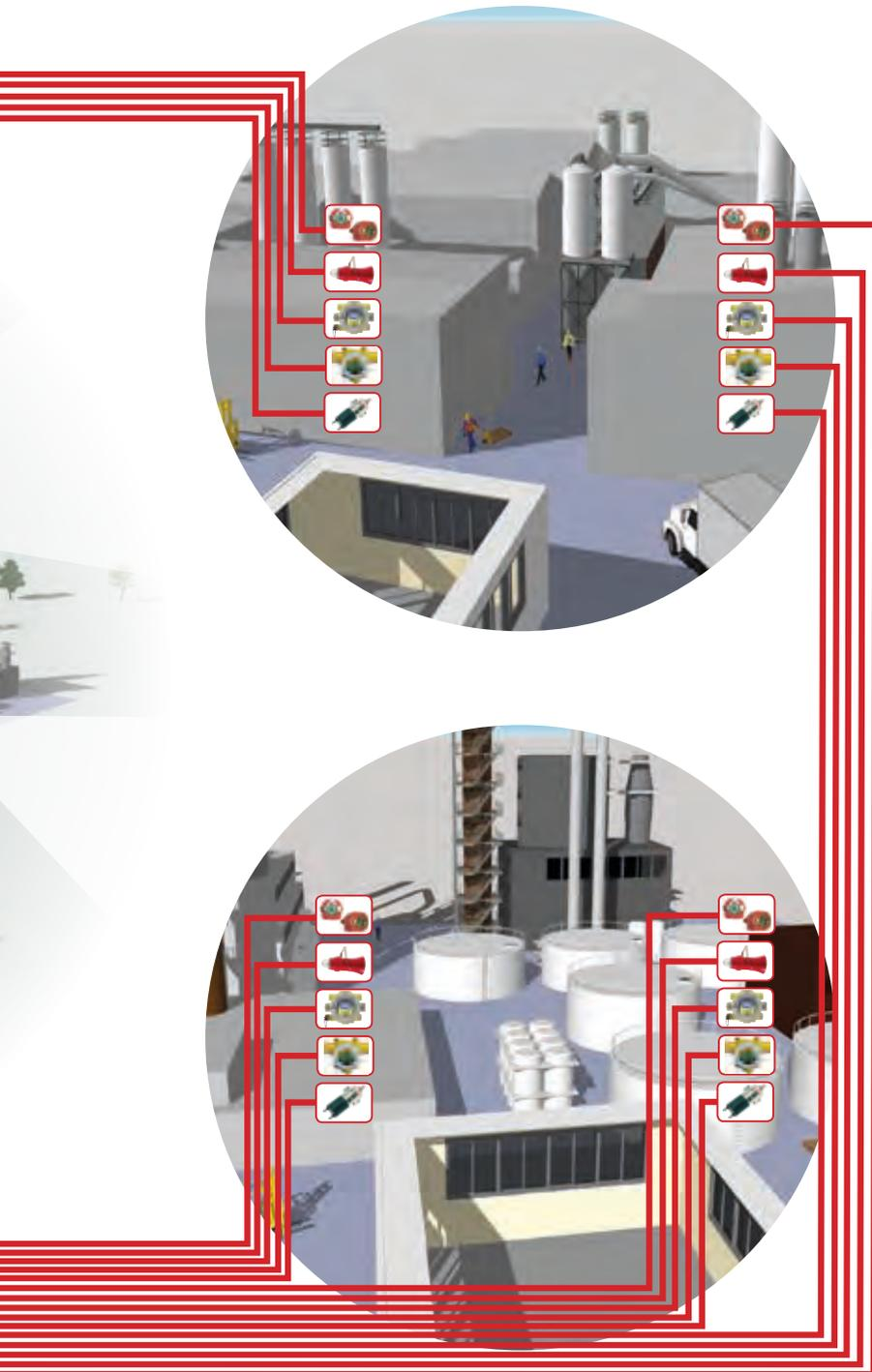
Mit einem kombinierten Ansatz kann beispielsweise ein vorhandenes System erweitert werden. Neue, durch eine Erweiterung des Fertigungsbereichs erforderliche Ein- und Ausgänge können mit einer dezentralen Touchpoint Pro-Einheit verbunden werden, während das vorhandene System und die Verkabelung direkt an den zentralen Controller angeschlossen sind.
